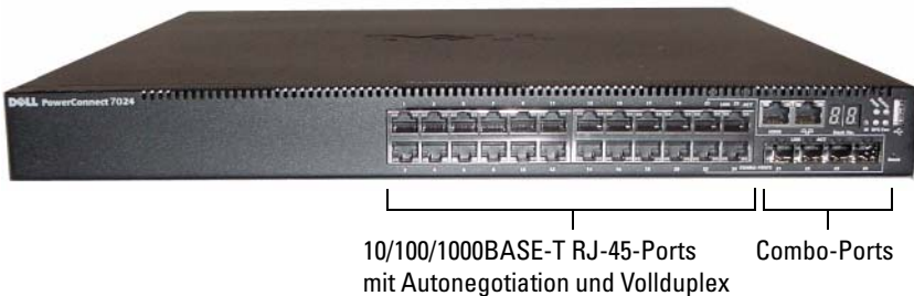
Abbildung 1-2. PowerConnect 7024P mit 24 10/100/1000BASE-T PoE Plus-Ports
