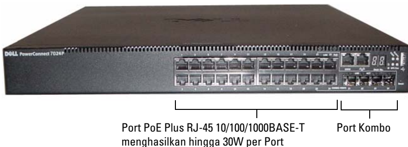
Gambar 1-2. PowerConnect 7024P dengan 24 Port PoE Plus 10/100/1000BASE-T
