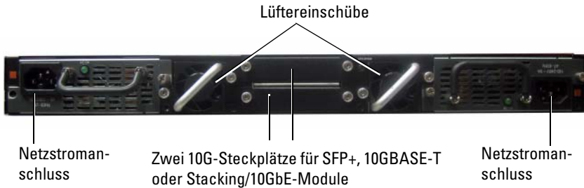
Abbildung 1-10. Rückseite des PC7048R
