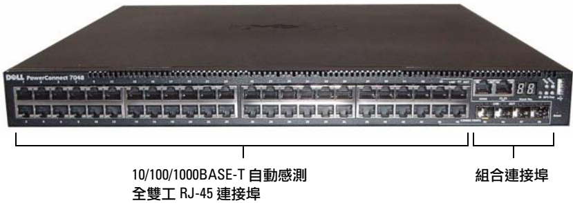
圖 1-4. PowerConnect 7048，具有 48 個 10/100/1000BASE-T 連接埠
